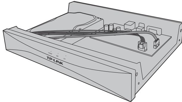
4.将机箱上盖安装回设备上，并拧紧螺丝固定。
